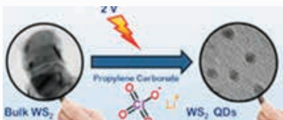
चित्र 2.5 : बड़ी मात्रा में WS 2 से WS 2 क्वांटम डॉट्स के एकल चरण विद्युत रासायनिक रूपान्तरण का प्रतिनिधित्व करती योजनाबद्धता
