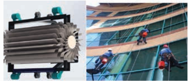
ऊंची-ऊंची इमारतों के लिए स्वचालित खिड़की की धुलाई और शुष्कन मशीन: गिरने के खतरे को कम करना
