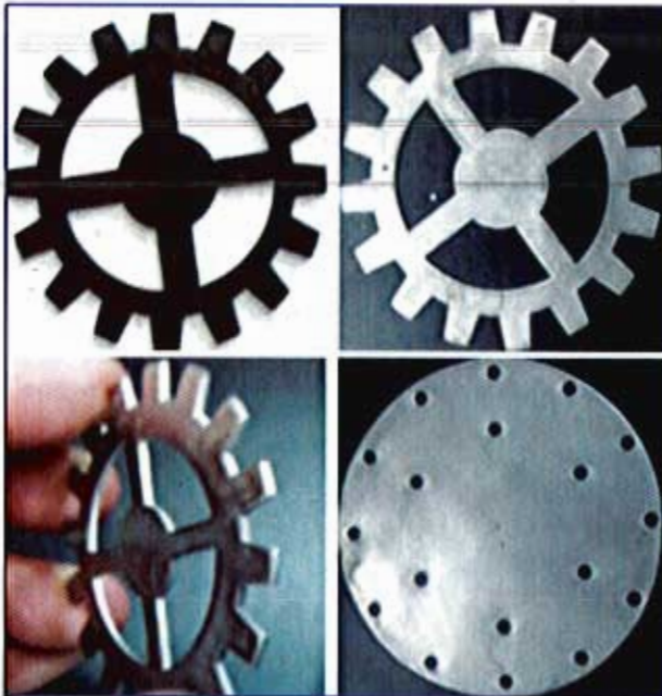
चित्र 29 इलेक्ट्रोलेस RGO-Ni नैनोकम्पोजिट कोटिंग घटक
