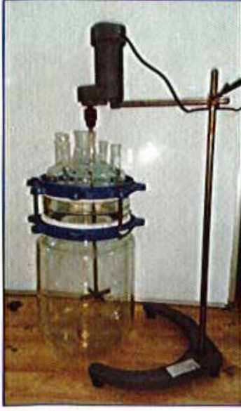
चित्र 23 ग्रेफिन ऑक्साइड के उत्पादनार्थ प्रयोगशाला का संस्थापन Oxide
