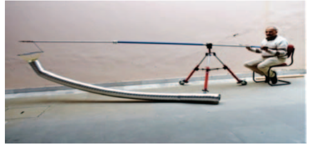
चित्र 1: फल तोड़ने वाले उपकरण का अंतिम प्रोटोटाइप
