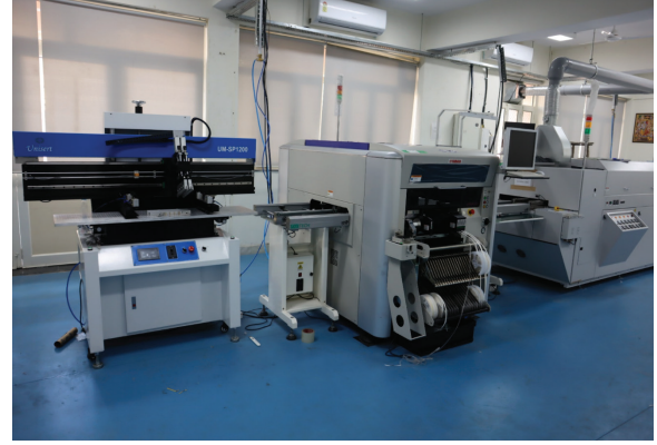
चित्र 2 : जयपुर में सरफेस माउंट टेक्नोलॉजी (एसएमटी) आधारित पिक एंड प्लेस रोबोटिक असेंबली यूनिट
