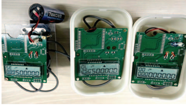
चित्र 4: स्टैटिक वॉटर मीटर का अंतिम विकसित प्रोटोटाइप - एक्वा मैनेजमेंट बाइनरी यूनिट
