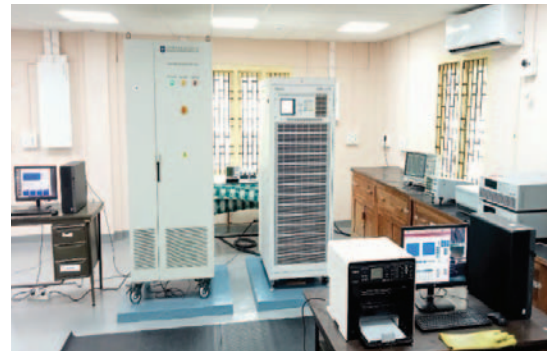
चित्र 6 (क) : 30 केवीए सौर इन्वर्टर परीक्षण सुविधा
