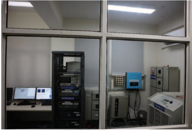
चित्र 1 : सीएसआईआर-सीरी जयपुर केंद्र में वास्तविक ग्रिड से जुड़े इन्वर्टर परीक्षण सेटअप
