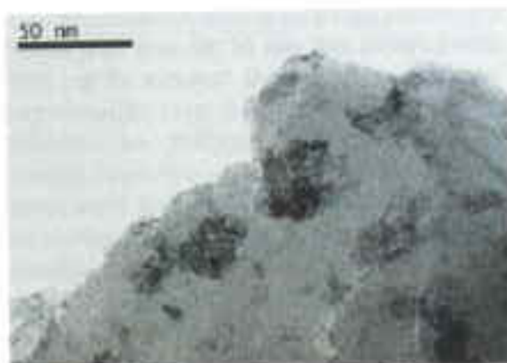
Fig. 1.42. SEM and TEM of CuO incorporated alumina
